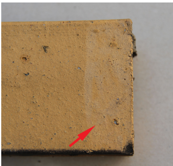
fot. 3 Niekorzystny efekt uszkodzenia warstwy spieku przy zastosowaniu Fassadenreiniger-Paste Remmers
